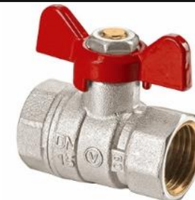
ONYX Robinet sferic, pasaj total, cu presetupă și fluture de aluminiu (versiunea cu filet interior-interior)
